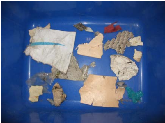
Abbildung 6: FT in einer Sortierprobe EBS Die gefundenen Stückzahlgehalte streuen im Bereich von 0,5 bis etwa 6%. Im Mittel handelt es sich bei etwa 2,5% aller Artikel > 15 mm um Chlorfrachtträger.
